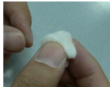
ทำความสะอาดสายใยแก้วเปลือย
